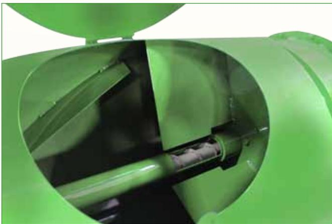
Dispone de un depósito con capacidad de 75 kilogramos que recibe el producto que se desea esparcir, con el funcionamiento de la toma de fuerza del tractor, el material es extraído por una flecha gusano que al girar lo envía al abanico, de ahí, es diseminado por el tubo esparcidor; éste último se puede girar a 360 grados, además de que sirve como canal de paso para que el material se espolvoree sobre la superficie a gran presión y se pueda tener un aprovechamiento eficiente del polvo.
