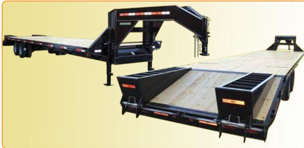
Un remolque equipado con dos rampas de uso rudo y “cola de pato”, estos dos aditamentos facilitan el ascenso de unidades con llantas, ya que al bajar las dos rampas, literalmente éstas quedan al nivel del piso, por lo que las maniobras para cargar maquinaria agrícola, de construcción o vehículos de cualquier tipo, se pueden realizar de manera sumamente fácil, incluso por una sola persona, con el mínimo esfuerzo; la “cola de pato” facilita aún más el ascenso de vehículos.
