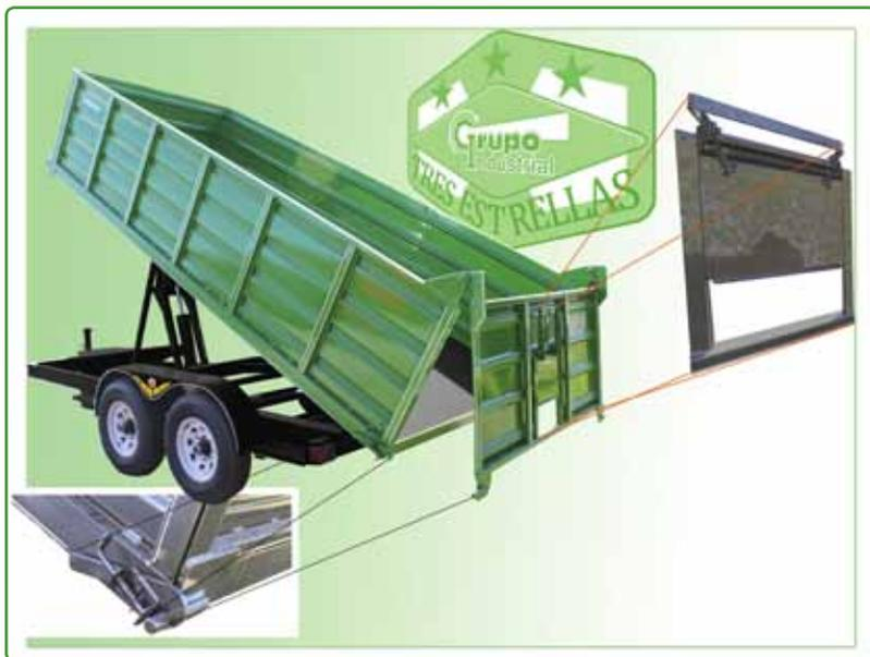
**E**n la fotografía de la parte izquierda, se pueden observar a detalle, la apertura de la puerta posterior; cabe hacer mención de lo simple que es accionar el cerrojo de apertura de la puerta, así como cerrarla, acciones que se realizan sin el menor esfuerzo, por las características del cerrojo y la palanca de apertura
