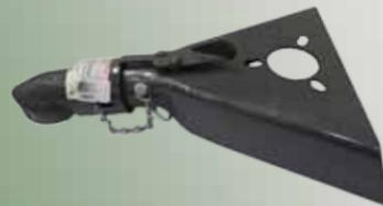
Jalón de acero fundido, reforzado, marca Bulldog, tipo A, con capacidad para 5,000 libras, para bola de 2 pulgadas.
