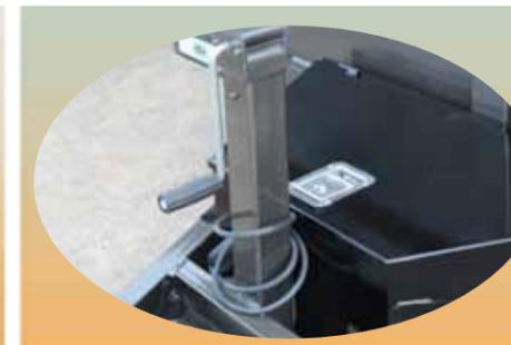
Cajón para herramienta fabricado en lámina, incluye chapa con llave; está instalado en la parte frontal del remolque.
