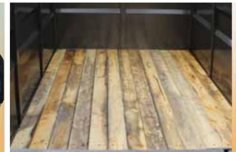
Plataforma de carga recubierta de madera tratada, de 2 pulgadas.
