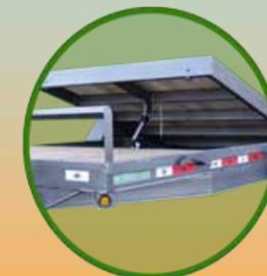
Plataforma de elevación, con pistón, actúa por el mismo peso del vehículo que se va a cargar.
