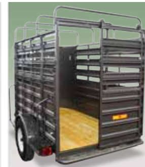
Puerta posterior en apertura corrediza. Se aprecia el piso de madera tratada de 1.5 pulgadas.
