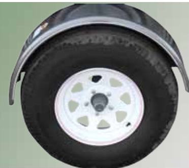
Eje sencillo, con dos rines y ruedas de 15 pulgadas, convencionales. cinco birlos. Guardafangos de medio círculo.
