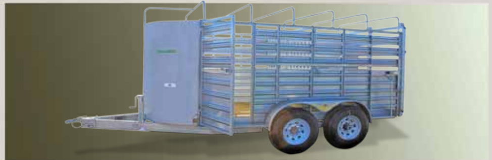
CUENTA CON PUERTA TRASERA, LATERAL E INTERMEDIA, ESTA ÚLTIMA DIVIDE EL ÁREA DE CARGA EN DOS ESPACIOS INDEPENDIENTES; PISO DE MADERA; ESTRIBOS EN LÁMINA ANTIDERRAPANTE.
