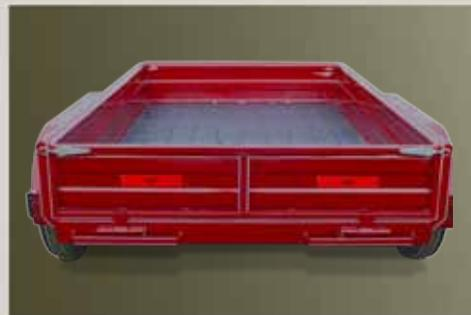
REFLEJANTES DISPUESTOS DE FORMA DIMENSIONAL, LUCES TIPO LED'S, PISO DE LÁMINA.
