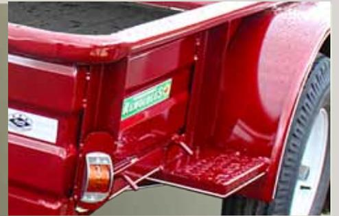
ESTIBOS CON LÁMINA ANTIDERRAPANTE, GANCHOS PARA SUJECIÓN DE CARGAS.
