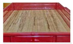
Piso de madera de pino tratada, de 1.5 pulgadas de espesor.
