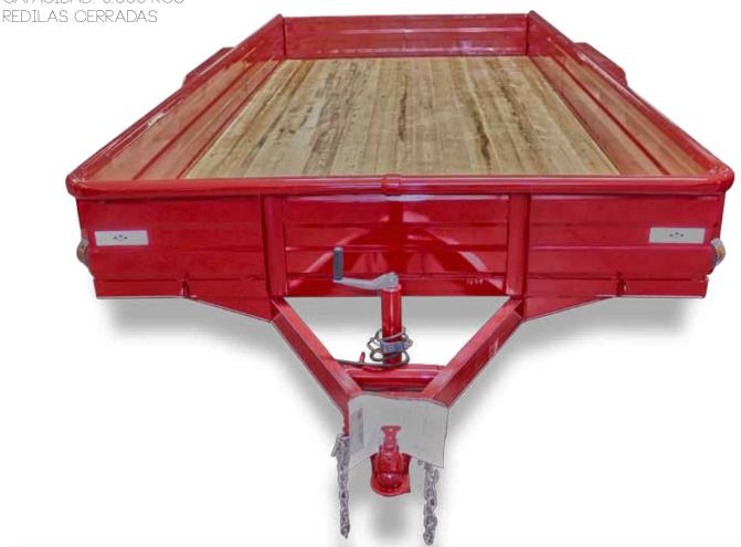
Presentamos el remolque cama baja modelo CB-7016 M3T, de entre sus características principales tenemos que la plataforma de carga tiene dimensiones de 7 X 16 pies, cuenta con capacidad de carga de 3,000 kilogramos.
