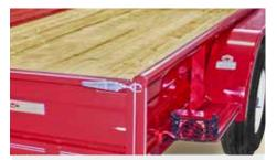
Estribos de lámina antiderrapante en ambos costados; así como ganchos para inmovilizar cargas.
