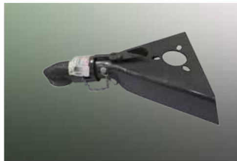
Jalón de acero fundido, reforzado, marca Bulldog, tipo A, con capacidad para 5,000 libras, para bola de 2 pulgadas.
