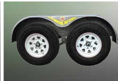
Doble eje, con cuatro rines y ruedas de 15 pulgadas, convencionales. Guardafangos tándem, tipo gota.
