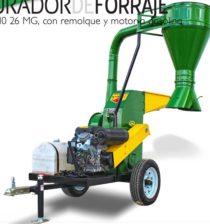
Nuestros molinos tienen capacidad para triturar todo tipo de forraje, el T -10 26 MG realiza la operación con martillos fijos, hechos de acero; tienen instalada una criba curva, con perforaciones que pueden ir desde 1/8 hasta 4 pulgadas, misma que determina el grosor de la molienda.
