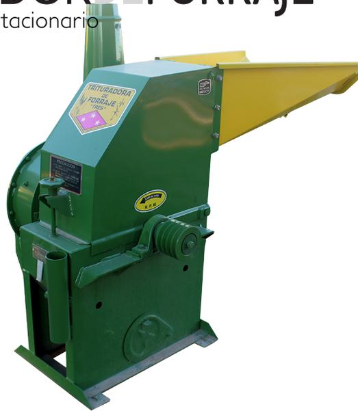
Nuestros molinos tienen capacidad para triturar todo tipo de forraje, el T -10 26 estacionario, realiza la operación con martillos fijos, hechos de acero; tienen instalada una criba curva, con perforaciones que pueden ir desde 1/8 hasta 4 pulgadas, misma que determina el grosor de la molienda.
