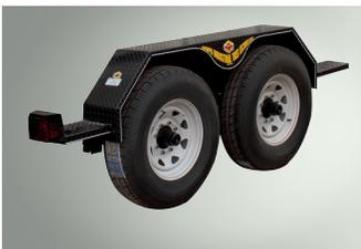
Fénder tipo Jeep, para doble rodada, fabricado en lámina antiderrapante. Llantas 16, con rines de 8 birlos.
