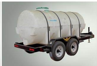
Depósito de plástico rolado, reforzado, sujeto con bridas y vástagos.
