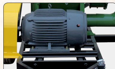
Motor Nidec, eléctrico, de tres fases y potencia de 30 HP.
