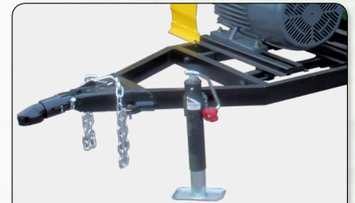
Detalle del gato de sustentación y jalón.
