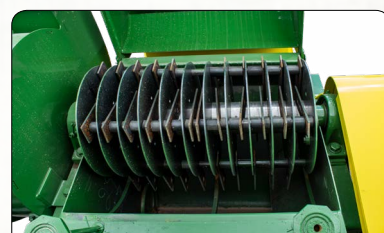
Cilindro de trituración de martillos sueltos.
