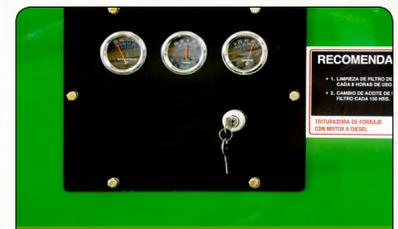
Tablero de control y switch de encendido.
