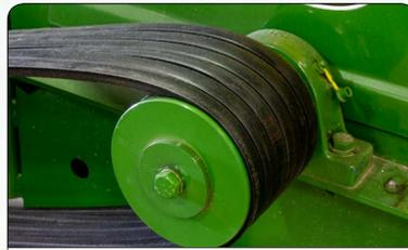
*Polea motriz ranurada para 6 bandas trapezoidales (tipo V).*
