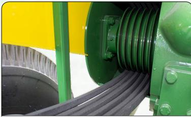
*Polea conducida, ranurada para 6 bandas trapezoidales (tipo V).*
