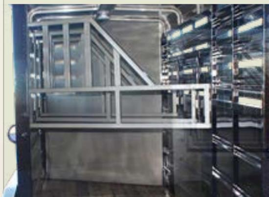
Foto del interior del remolque, donde se observan los separadores que dividen el espacio de carga.
