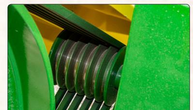
*Polea conducida y las seis bandas trapezoidales.*
