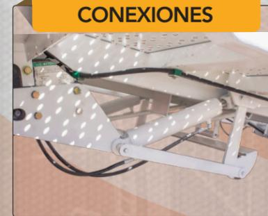
Las conexiones y mangueras hidráulicas son de alta presión, para el adecuado funcionamiento del sistema de levante. Los cilindros hidráulicos están montados en una estructura tipo tijera, que reduce los esfuerzos en el cilindro, dispersándolos en la totalidad de la estructura.
