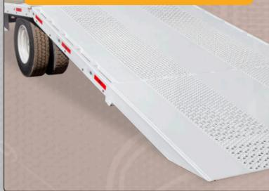
Aquí se observan las dos secciones desplegadas hasta el nivel de suelo, con lo que se facilitan las maniobras para ascender cargas a la plataforma.
