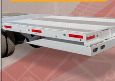
En la imagen, la plataforma en modo transporte, la primer sección totalmente horizontal, en línea con la plataforma rígida; la segunda sección, retraída, se coloca en la parte inferior de la primera sección.
