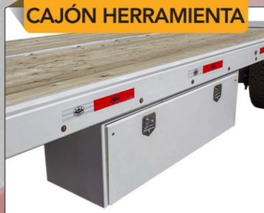
En el costado izquierdo, en la parte inferior de la plataforma se instaló un cajón para herramienta metálico, con dos chapas.
