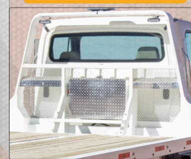
La cabecera, además de resistencia, combina estética y funcionalidad, con una elegante placa antiderrapante cromada, en la parte posterior de ésta, se ubicó el depósito para almacenar el aceite con el que opera el sistema hidráulico. Ahí alberga el winch, con capacidad para 4,536 kg, para facilitar el ascenso y descenso de cargas.
