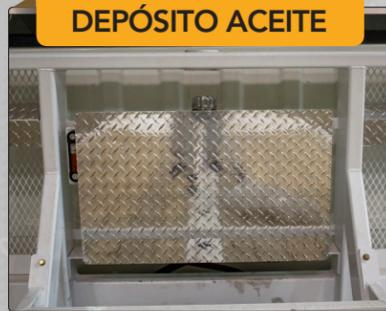
Depósito de aceite para alimentar el sistema hidráulico, con una capacidad para almacenar 50 litros, con su respectivo medidor de contenido.
