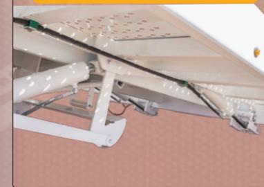
Vista de los dos cilindros hidráulicos de la segunda sección, es decir, controlan la sección de la plataforma que se localiza en el extremo final. La sección que opera es la que desciende hasta el nivel del suelo; en modo transporte se repliega hacia la parte interior de la plataforma.
