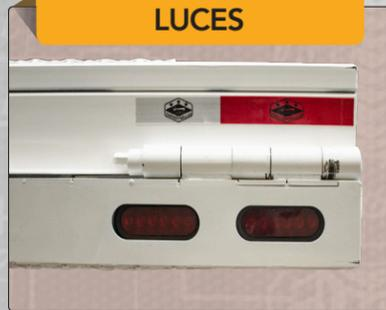
Las bisagras que unen las dos secciones desplegables son de un diámetro de 2 pulgadas.
