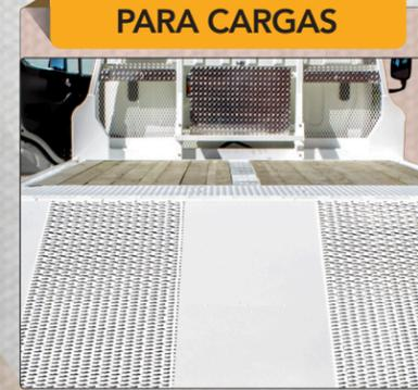
En las secciones metálicas, las que se pueden desplegar y contraer, para mayor agarre de los neumáticos en la superficie de la plataforma de carga (cuando se requiera el ascenso de automotores), se instaló una malla electrosoldada.
