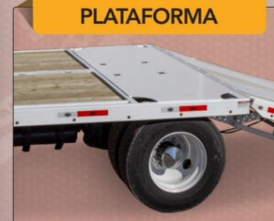
La parte de la plataforma que es rígida, que no se pliega, está recubierta con madera, con un refuerzo metálico en el centro; la parte final de ésta es de placa antiderrapante.
