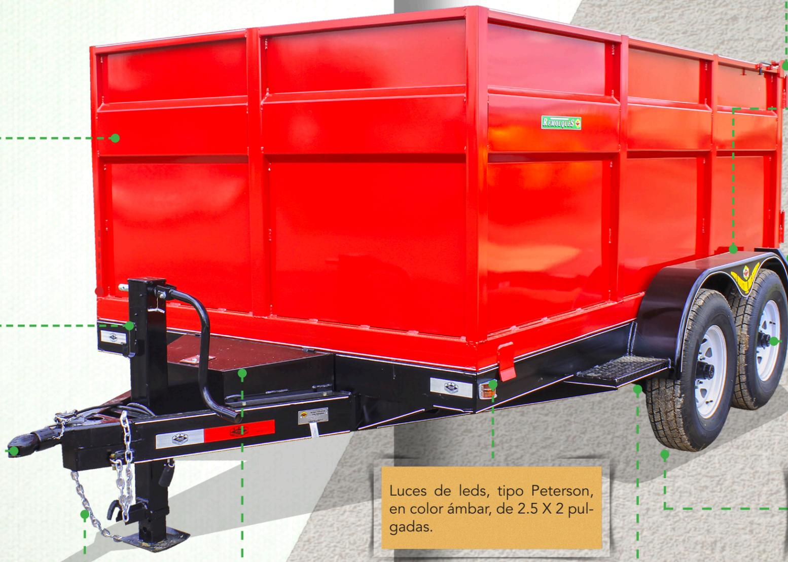
Las redilas son cerradas de 48 pulgadas de altura, conformadas plásticamente.
