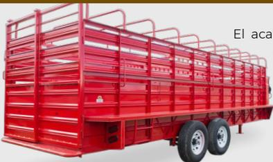
El acabado general es de alta precisión, el diseño se efectúa en un software CAD, los componentes de metal se procesan con equipo de corte y tornos CNC.
